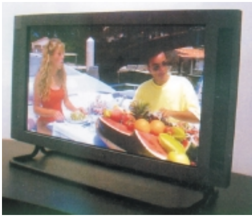
Figura 6. Prototipo de pantalla TV color mural de 50" realizada en plasma. Cortesía Panasonic.
